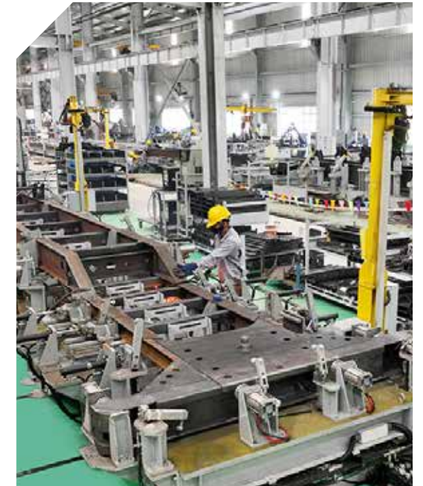
3 HÀN LIÊN KẾT KHUNG CHASSIS WELDING OF THE CHASSIS FRAME
