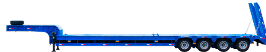
Sơ mi rơ móc chuyên dụng chở xe, máy chuyên dùng hoặc container FR (4 trục) Quad-axle drop deck
