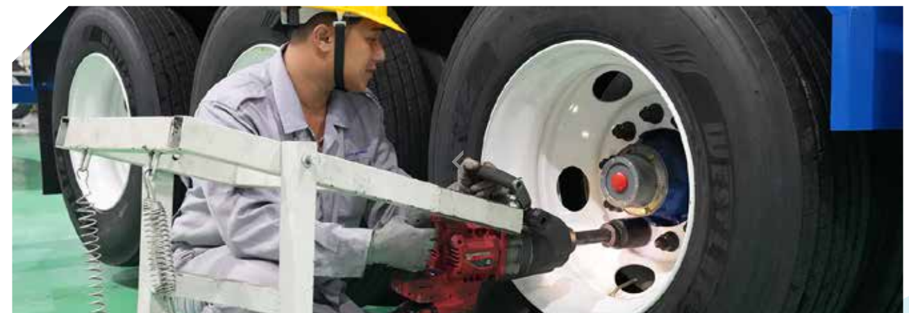
5 LẮP RÁP LỐP XE TIRE ASSEMBLY
