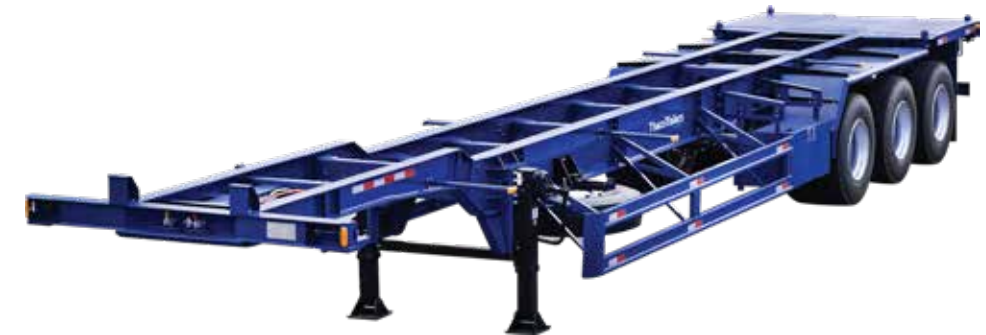
Sơ mi rơ moóc xương cổ cò 3 trục 45' 6 khóa 45' Skeletal Gooseneck Tandem, 6 Twist Locks
