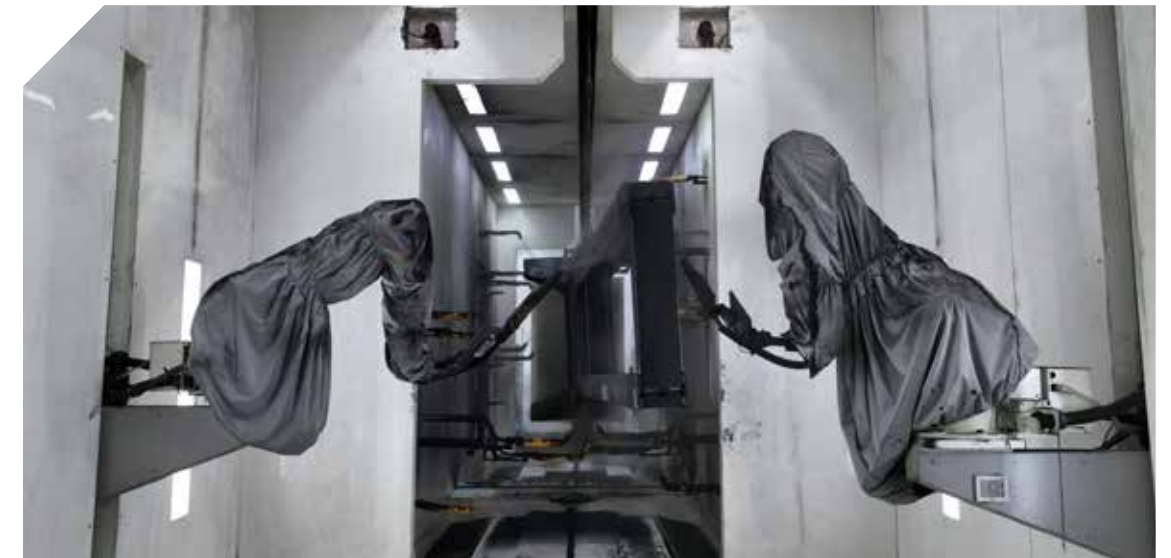
ROBOT SƠN TĨNH ĐIỆN BỘT AUTOMATIC POWDER COATING ROBOT
