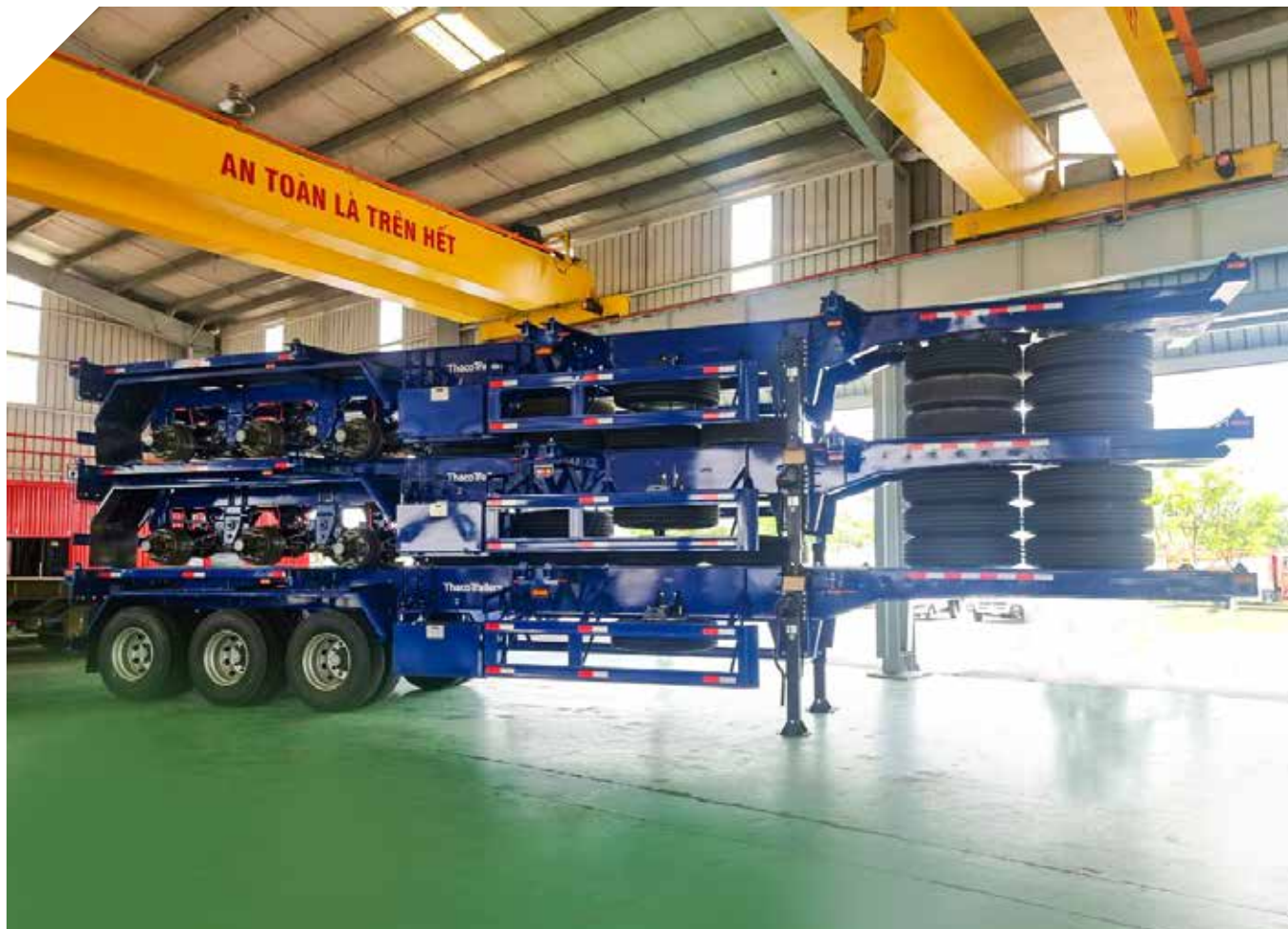
1 SẮP XẾP VÀ KIỂM TRA STACKING INTO BUNDLE AND INSPECTION
