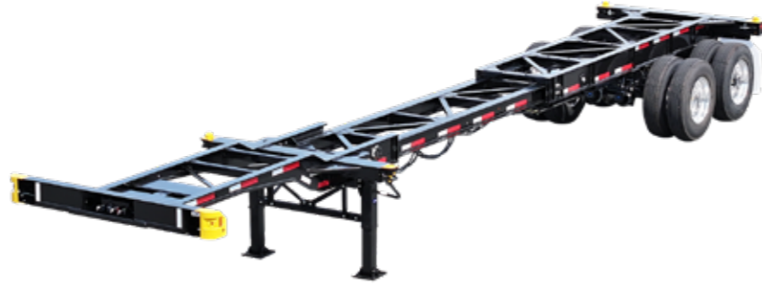
Sơ mi rơ moóc xương kết hợp 20'/40' (City Combo) 20'/40' City Combo Tandem
