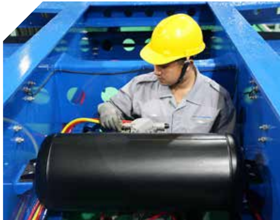
1 LẮP RÁP HỆ THỐNG HƠI AIR SYSTEM ASSEMBLY
