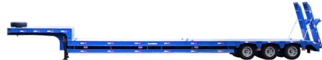
Sơ mi rơ móc chuyên dụng chở xe, máy chuyên dùng hoặc container FR (3 trục) Tri-axle drop deck
