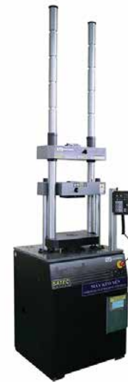
Máy kéo nén (Kiểm tra tính cơ lý của vật liệu) Universal Testing Machine (for testing mechanical properties of materials)
