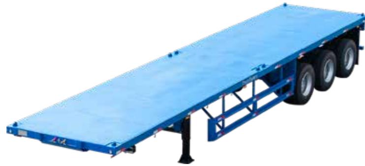
Sơ mi rơ móc sàn 3 trục 40' 8 khóa (33.1 tấn) 40' Flatbed Tridem, 8 Twist Locks (33,1 tons)
