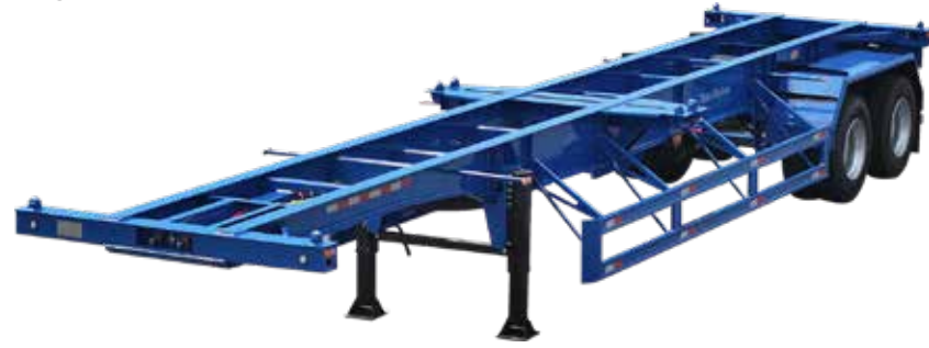
Sơ mi rơ moóc xương 2 trục 40' 8 khóa 40' Skeletal Tandem, 8 Twist Locks
