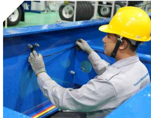
2 LẮP RÁP HỆ THỐNG ĐIỆN ELECTRICAL SYSTEM ASSEMBLY
