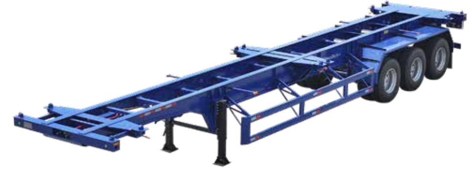
Sơ mi rơ moóc xương 3 trục 45' 12 khóa 45' Skeletal Tridem, 12 Twist Locks
