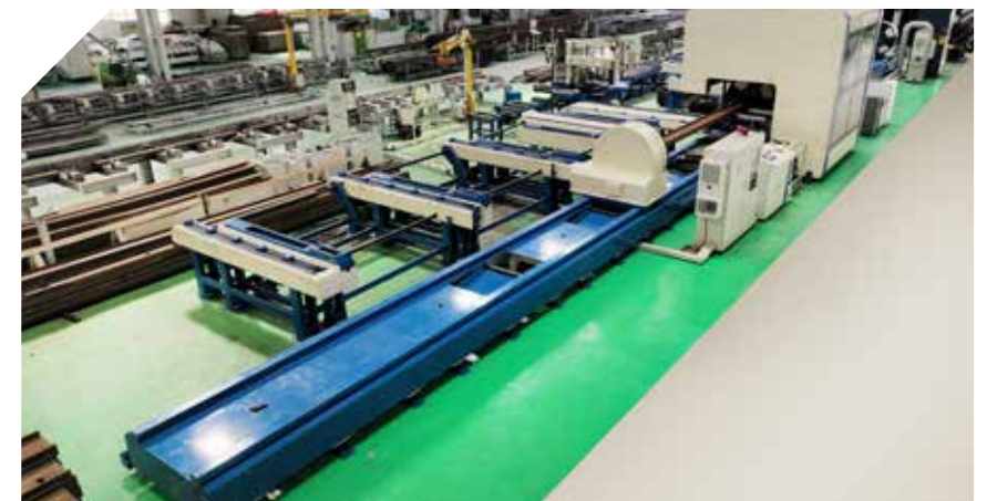
MÁY CẮT LASER DẦM I I-BEAM LASER CUTTING MACHINE
