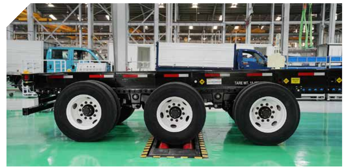
1 KIỂM TRA HỆ THỐNG PHANH BRAKE SYSTEM INSPECTION
