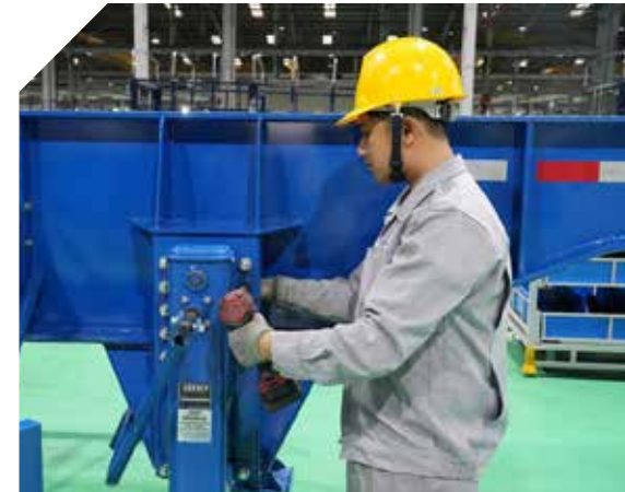
3 LẮP RÁP CHÂN CHỐNG LANDING GEAR ASSEMBLY
