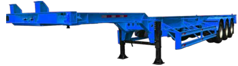
Sơ mi rơ moóc xương cổ cò 3 trục 40' 4 khóa 40' Skeletal Gooseneck Tandem, 4 Twist Locks
